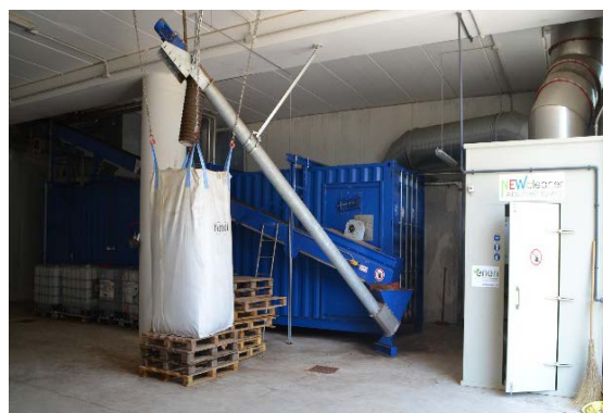
Figure 8.3: Digestato essiccato (a sinistra), camera di essiccazione con all'interno il nastro ventilato (blu), scrubber per il recupero dell'azoto ammoniacale nell'evaporato (bianco) ed insacchettamento del prodotto in big bag (Foto CRPA).
