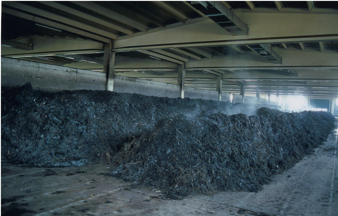
Figura 7.3: compostaggio in cumuli rivoltati di frazione solida di digestato e verde pubblico
