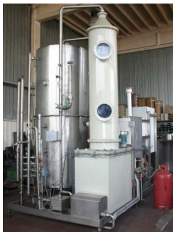
Figura 4.3: Impianto pilota con reattore di strippaggio in acciaio e la colonna di assorbimento dell'azoto ammoniacale in polipropilene.
