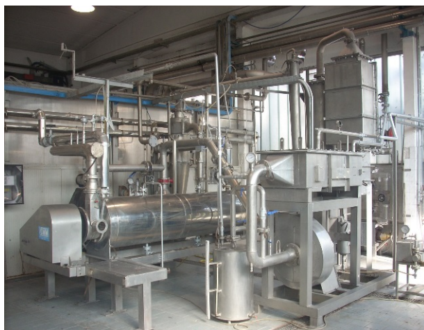
Figura 8.4: Impianto di turbo essiccazione con rotore interno ed a circuito chiuso.
