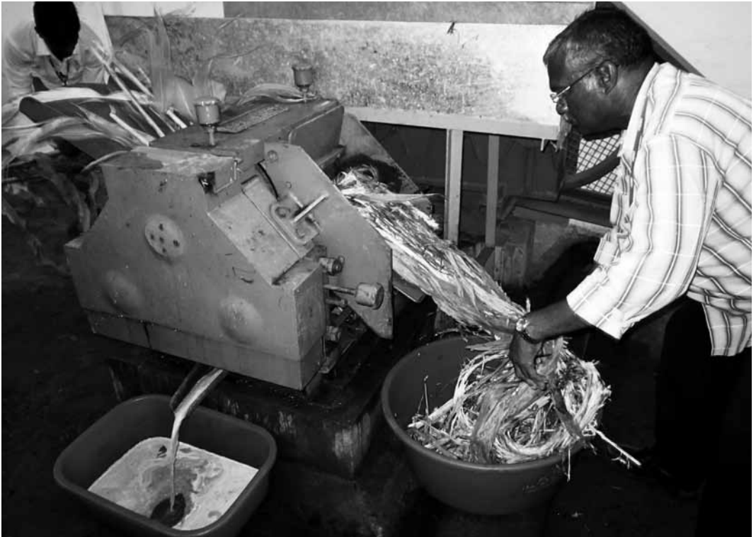
Figure 9: unità di separazione solido-liquido presso ICRIAT, Hyderabad, Andhra Pradesh (India) 60
