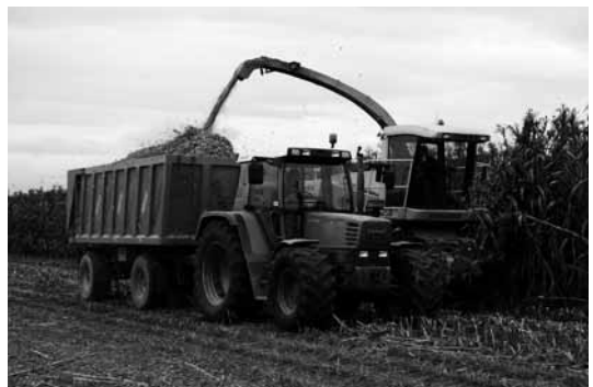
Figure 3: raccolta del sorgo zuccherino mediante una falcia-trincia-caricatrice mutuata dalla maidicoltura 31
