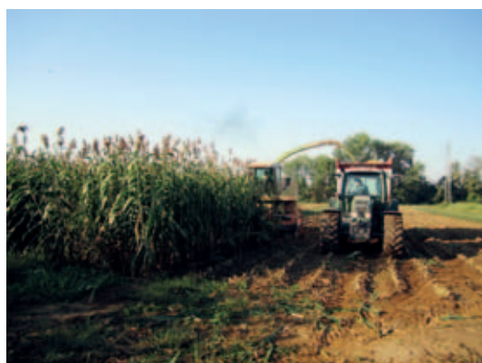
Figura 12: falcia-trincia-caricatrice in azione durante la raccolta in Pianura Padana, Italia 53
