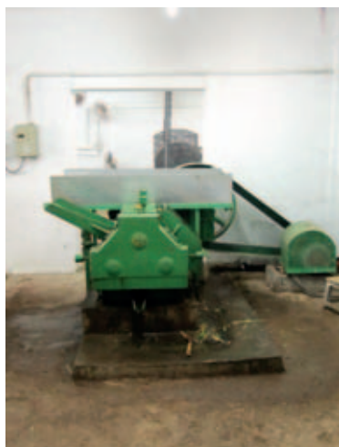
Figura 35: unità di separazione solido-liquido presso ICRISAT, Hyderabad, Andhra Pradesh (India) 146
